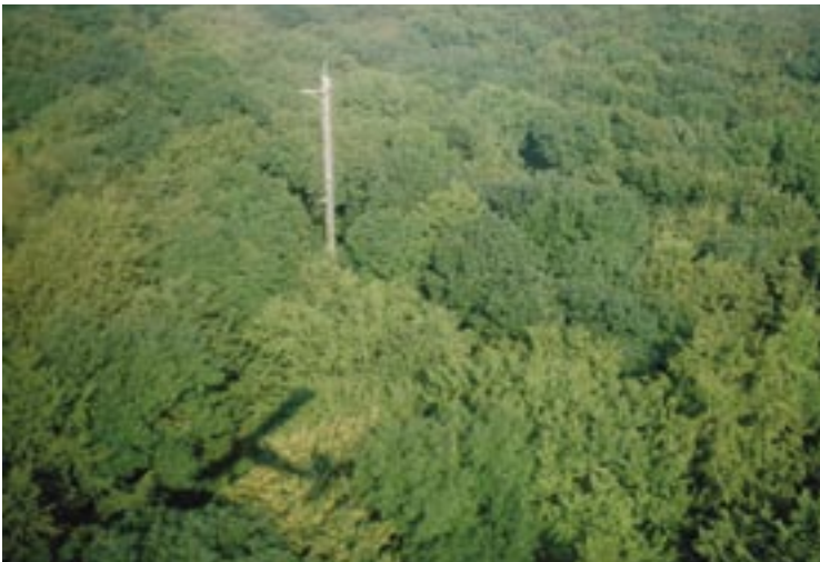
Avrupa'daki bir ormanında yer alan karbon akışı ölçüm kulesi Kaynak: M. Schumacher, CarboEurope, 2002.
