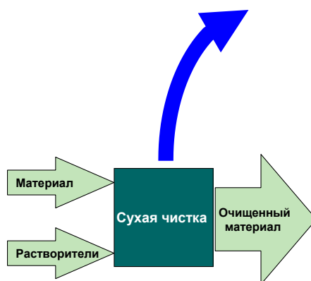
Рисунок 2-1 Схема технологического процесса для категории источника 2.D.3.f Химическая (сухая) чистка
