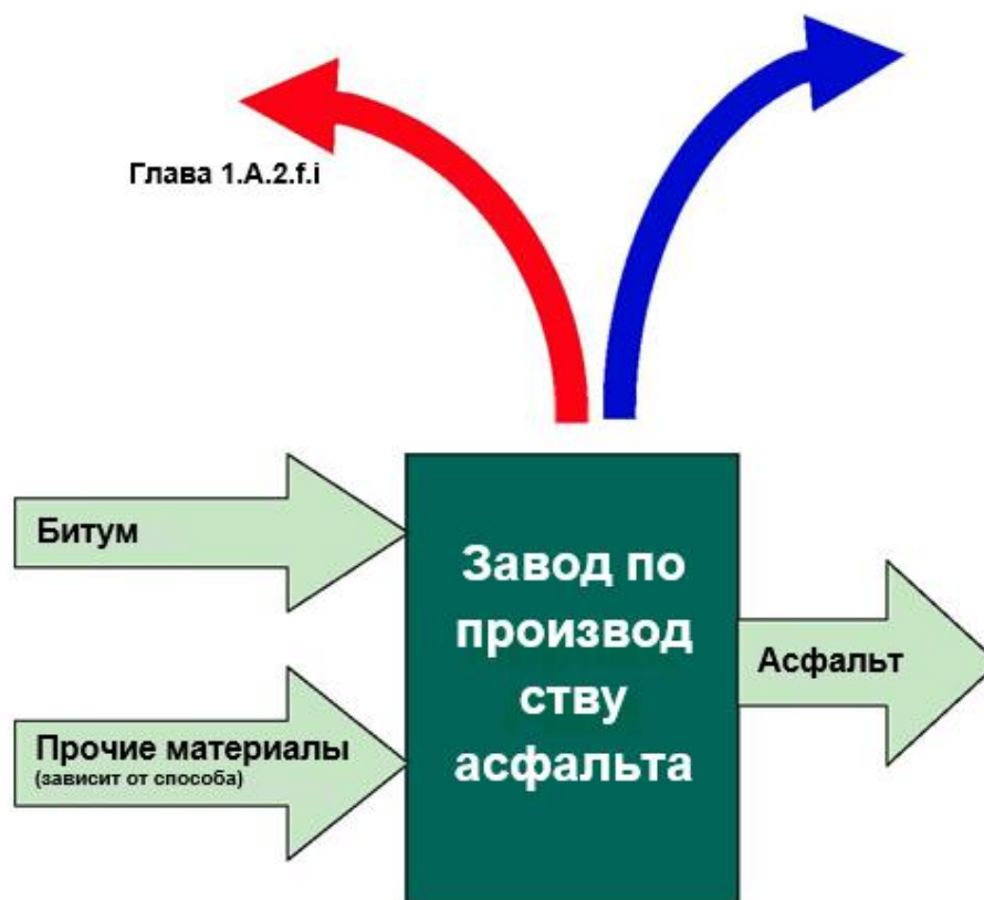
Рисунок 2-2 Общая схема процесса для категории источника 2.A.6 Асфальтирование дорожного полотна. Красная стрелка представляет выбросы при сжигании (относится к категории источника 1.A.2.f.i) и синяя стрелка представляет выбросы процесса (рассматриваемые в настоящей главе).
