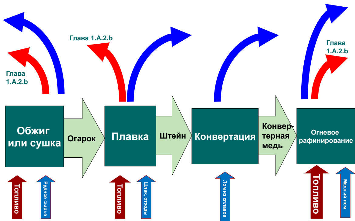
Рисунок 2-1 Схематическое описание объединённого процесса производства первичной/вторичной меди с использованием рудного концентрата с кремнезёмистым флюсом, шлаки, лом из сплавов или медный лом в качестве загружаемого материала, анодной меди в качестве исходного материала – при огневом рафинировании.
