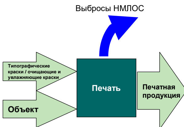
Рисунок 2-1 Технологическая схема для категории источника 2.D.3.h Печать
