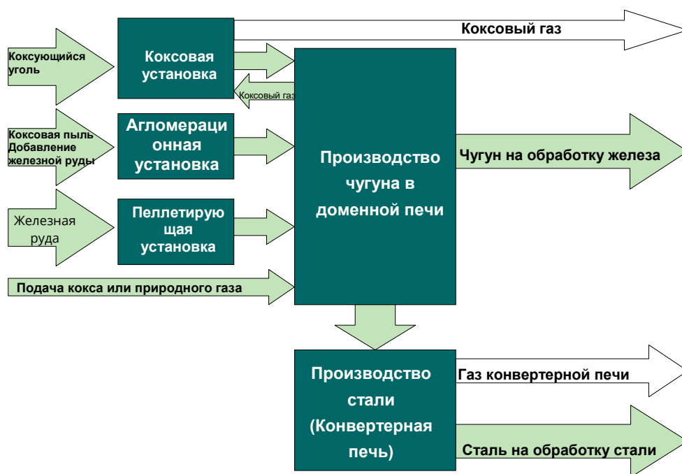
Рисунок 2-1 Основные технологические процессы черной металлургии; крайняя левая часть - сырье на входе комплекса технологического процесса, крайняя правая часть - продукты производства. Данный рисунок взят из Руководства IPCC (2006). (коксовый газ)
