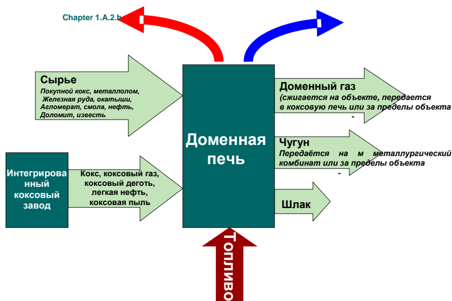
Рисунок 2-2 Технологическая схема производства железа. Красная стрелка представляет собой выбросы, образующиеся в процессе горения (регистрируемые в категории источников 1.A.2.b); синяя стрелка указывает на технологические выбросы (регистрируемые в этой категории источников).
