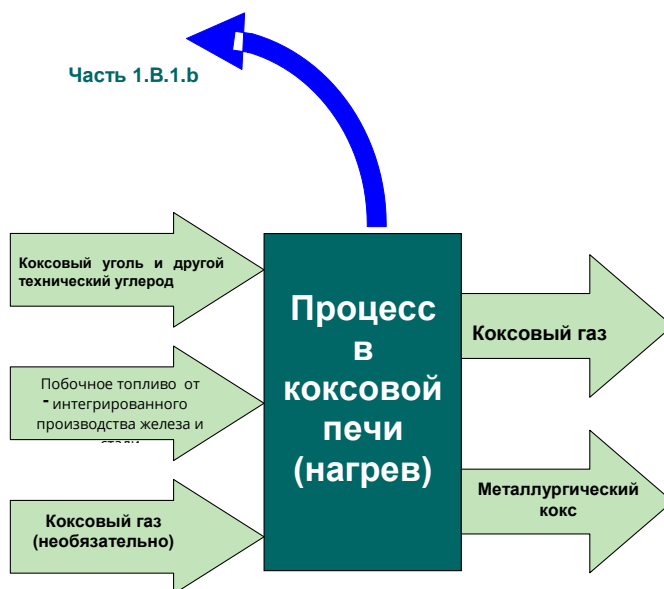
Рисунок 2.1 Технологическая схема производства кокса. Регистрировать выбросы при работе коксовой печи принято в категории источников 1.В.1.в.
