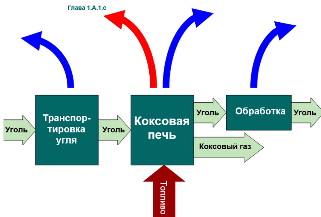
Рисунок 2-1 Технологическая схема для коксообразования, наиболее важный процесс, относящийся к категории источников 1.В.1.в Преобразование твердого топлива; выбросы, образующиеся при сжигании в коксовых печах, рассматриваются в главе 1.А.1.с.
