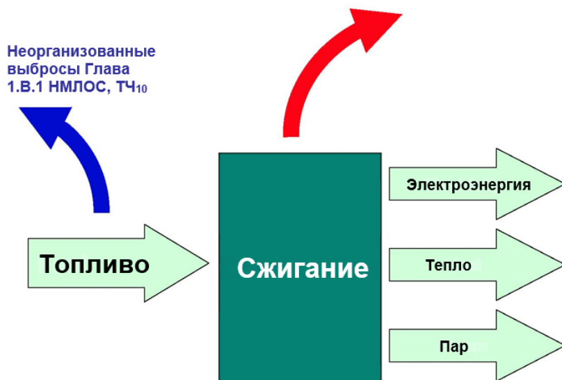
Рисунок 2-1 Пример основного технологического процесса в установках малого сжигания; рисунок взят из Методических указаний МГЭИК 2006 о составлении национальных инвентаризаций выбросов парниковых газов
