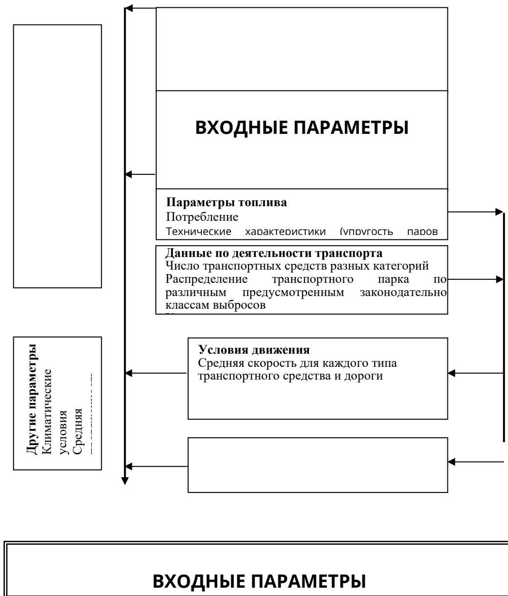
Рисунок 3-2 Блок-схема применения метода базовой линии
