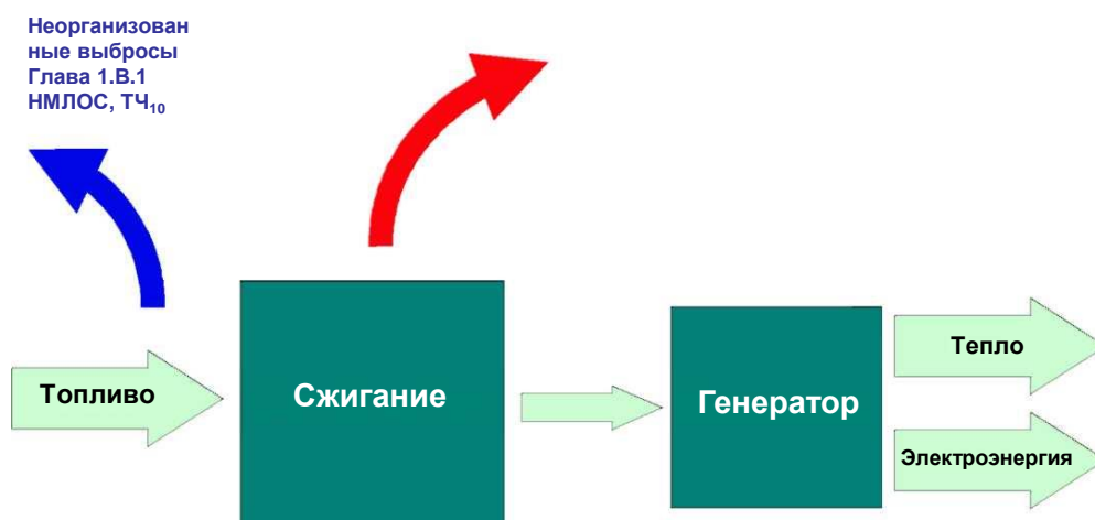
Рисунок 2-2 Схема технологического процесса для электростанции, основанная на IPCC Рис. 2.2. в главе Отрасли энергетической промышленности
