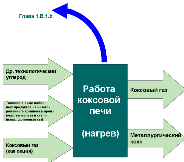
Рисунок 2.2 Технологическая схема производства кокса. Регистрировать выбросы при работе коксовальной печи принято в категории источников 1.В.1.в.
