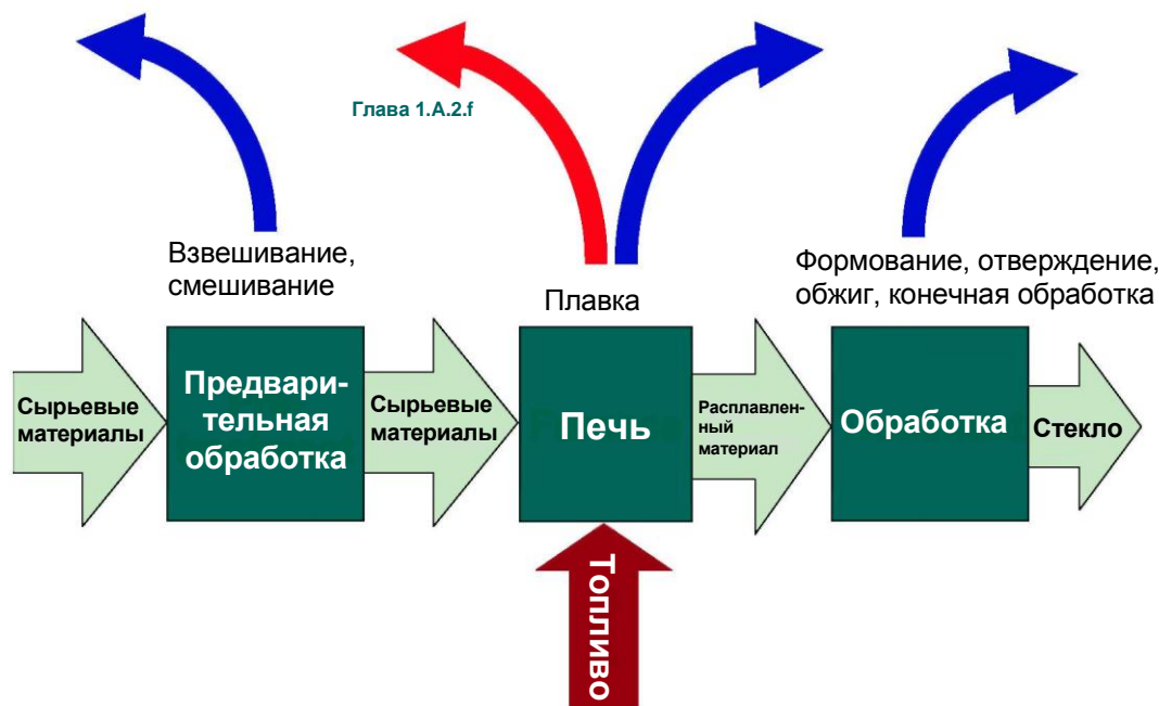
Рисунок 2.1 Технологическая схема 2.А.3 Добыча других полезных ископаемых, применяемых для производства стекла
