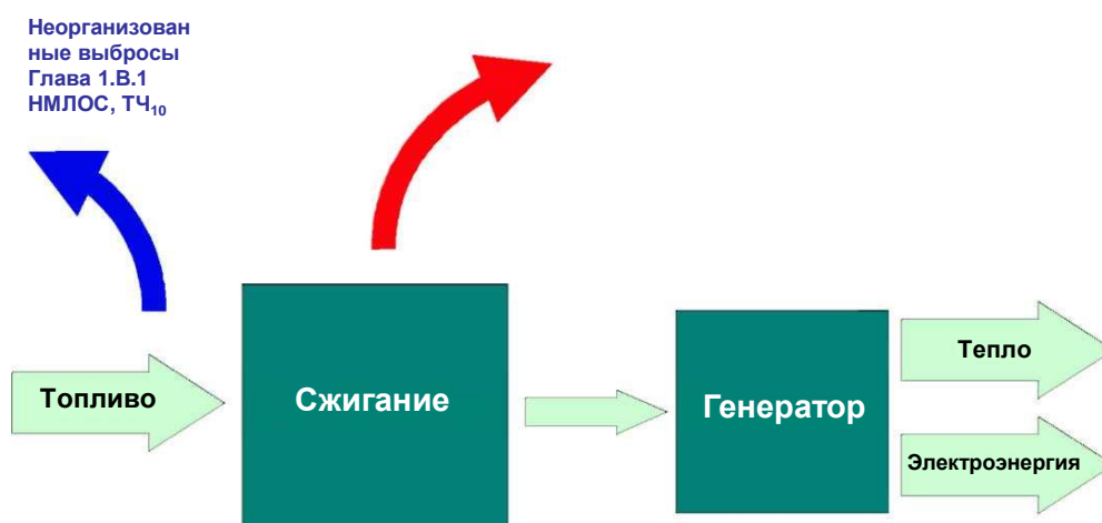
Рис. 2-2. Схема технологического процесса для электростанции, основанная на IPCC
