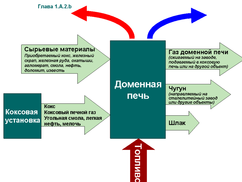
Рисунок 2.4 Технологическая схема производства железа. Красная стелка представляет собой выбросы, образующиеся в процессе горения (регистрируемые в категории источников 1.А.2.в); синяя стелка указывает на технологические выбросы (регистрируемые в этой категории источников).
