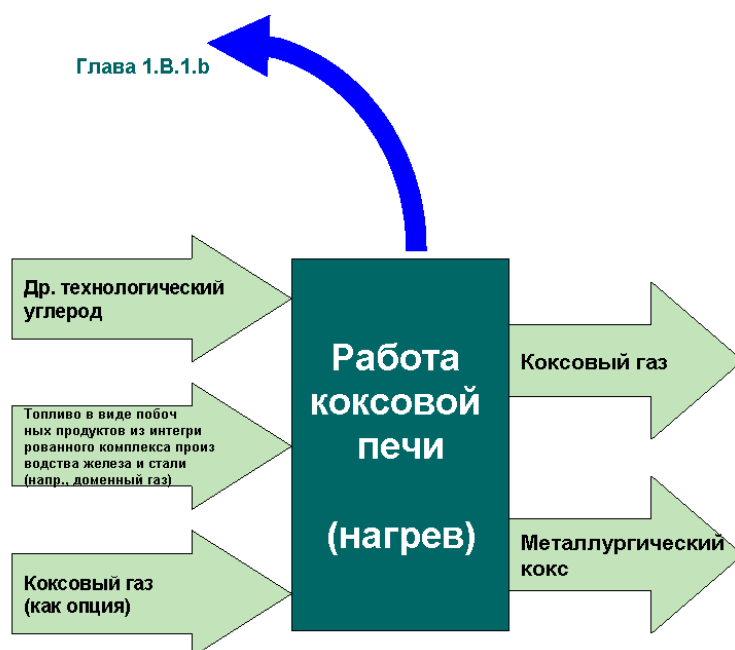
Рисунок 2.2 Технологическая схема производства кокса. Регистрировать выбросы при работе коксовальной печи принято в категории источников 1.В.1.б.
