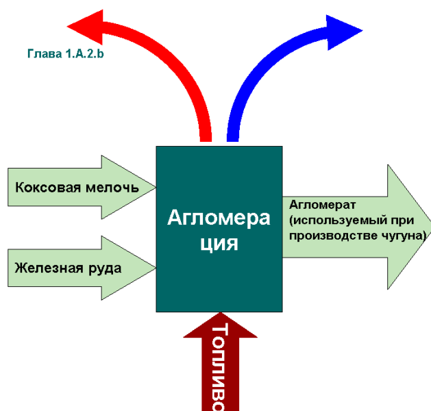
Рисунок 2.3 Технологическая схема производства окатышей. Красная стрелка представляет собой выбросы, образующиеся в процессе горения (см. категорию источников 1.А.2.б); синяя стрелка указывает на технологические выбросы (регистрируемые в данной категории источников).
